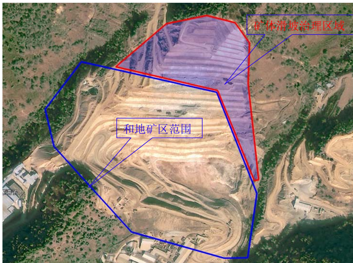
图 5-2 矿区范围与矿体边坡滑坡治理区域示意图
