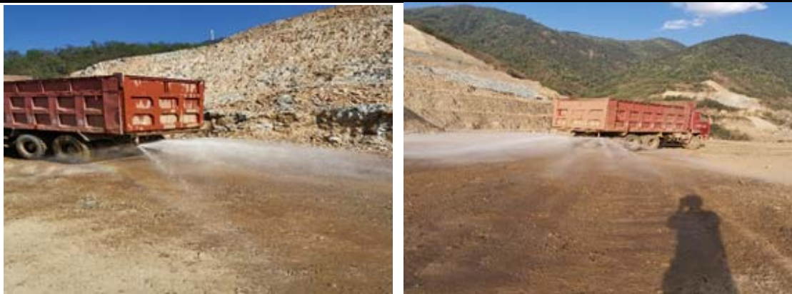
矿山洒水降尘
